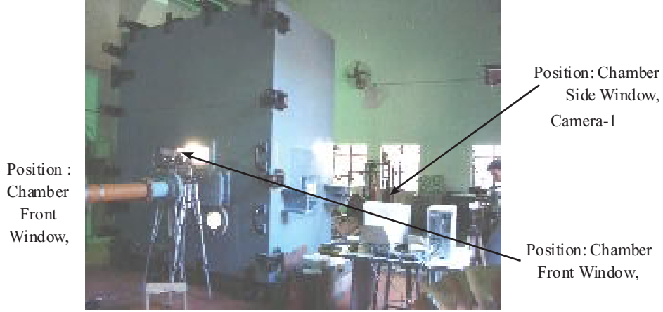
चित्र 2 स्पिन कैमर के पास उच्च गति कैमरा की स्थिति।
