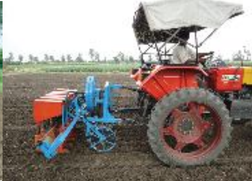
चित्र 4 तथा 5. ट्रैक्टर चलित औषधीय छोटे-छोटे औषधीय बीजों के लिए प्लान्टर।
