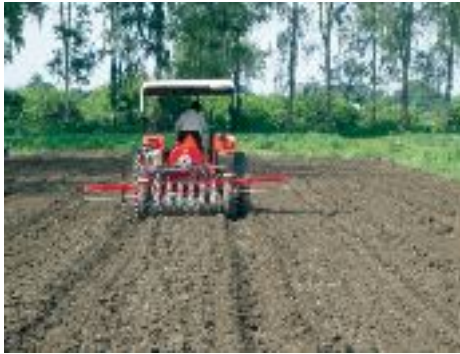
चित्र 4 तथा 5. ट्रैक्टर चलित औषधीय छोटे-छोटे औषधीय बीजों के लिए प्लान्टर।
