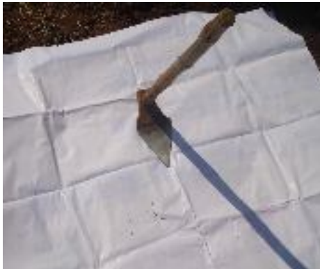
चित्र 6. मानव के द्वारा औषधीय फसलों की खुदाई यंत्र।
