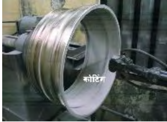
चित्र 3. कंप्रेसर केसिंग No. 2 Metco 450 + metco 320 ।
