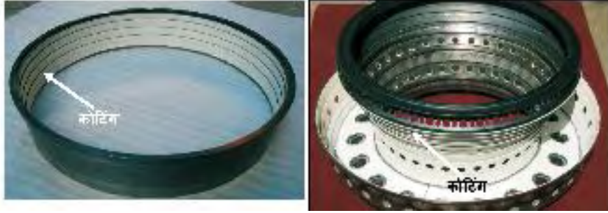
चित्र 5. लाइनर कोटिंग TBC (Amdry 962+ metco 204 |
