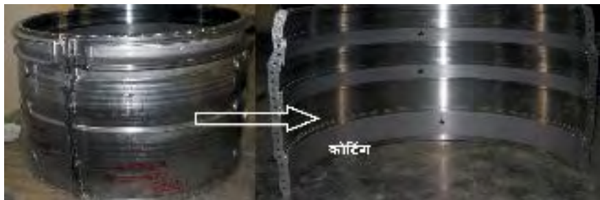
चित्र 2. स्पलिट फैन केसिंग Metco 450 + metco 601।
