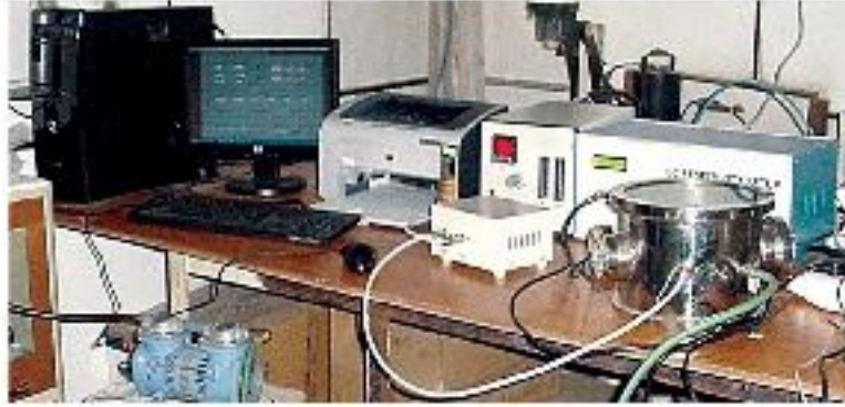
चित्र 3. SSPL में संवेदक से गैसों की संवेदनशीलता के परीक्षण के लिये DC रेसीस्टीविटी संयंत्र।
