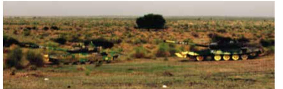
फील्ड क्षेत्र में अनुकूलनीय थर्मल ऐड-ऑन के साथ पृष्ठभूमि मिलान और छद्मावरण प्रभावशीलता
