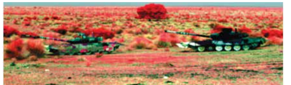
बहु-स्पेक्ट्रल छद्मावरण स्टिकर्स (रंग और एफसीसी छवि) का क्षेत्र मूल्यांकन
