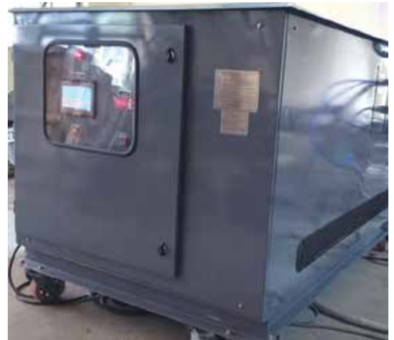
उच्च ऊर्जा लेजर-आधारित DEW प्रणाली के लिए गुप्त ऊष्मा भंडारण आधारित ऊष्मा प्रबंधन इकाई
