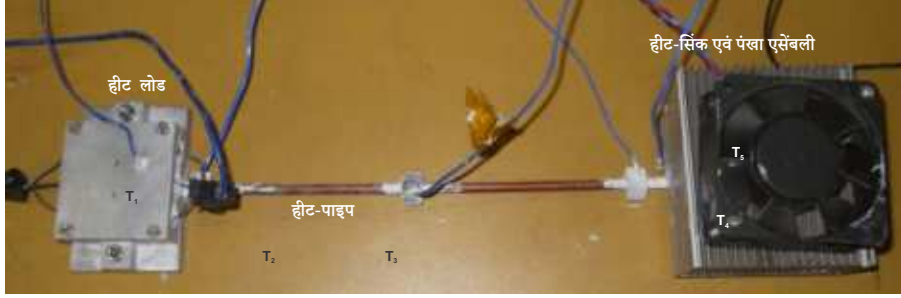
चित्र-1: एक्सपेरिमेंटल सेट-अप (T 1 – हीट लोड का तापमान, T 2 – हीट-पाइप के एक सिरे का तापमान, T 3 – हीट-पाइप के मध्य का तापमान, T 4 – हीट-पाइप के दूसरे सिरे का तापमान, T 5 – हीट सिंक का तापमान)
