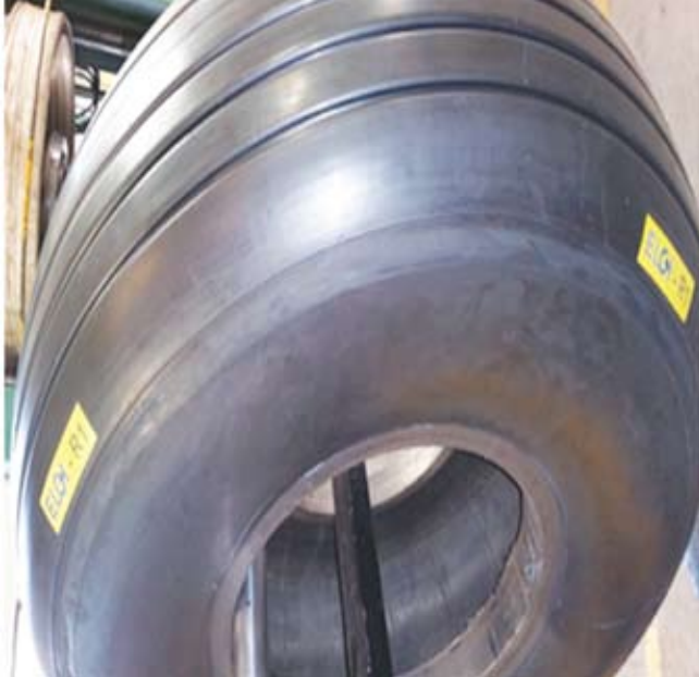
आई एल 76 परिवहन वायुयान टायर पर पहली बार रबर चढ़ाया गया है
